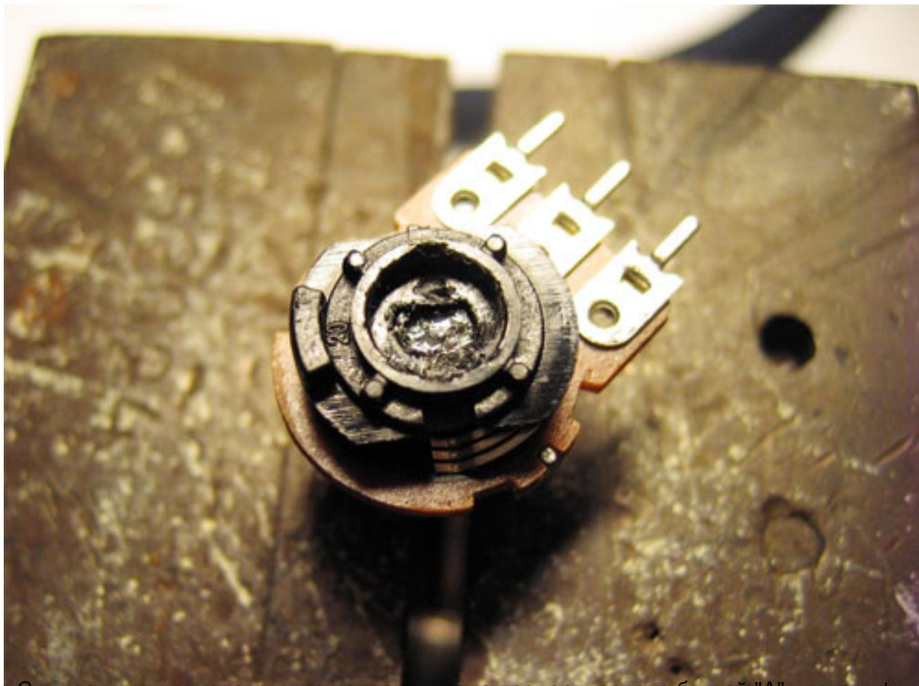
Снимаем движок, смотрим на подложку - она промаркирована буквой "А" - логарифм.
