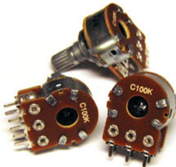
Обратнологарифмические переменные резисторы штука довольно редкая. При этом есть несколько хороших diy проектов в которых без них не обойтись. Приготовить несколько сдвоенных переменных резисторов с характеристикой "C" (rev log audio pots) можно из сдвоенных логарифмических переменных резисторов производства фирмы Alpha...
