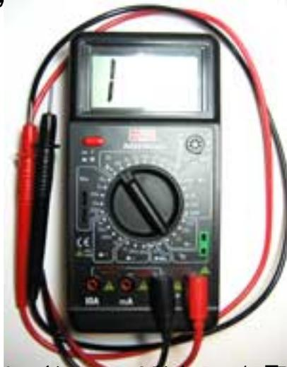
Мультиметр (или аналогичный) для измерения сопротивления, напряжения, тока и т.д.
