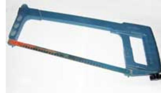
Используется для резки металла, дерева, пластика, резания длинных валов
