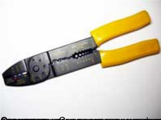
Используются для обжима проводов (внутри провода) и для зачистки проводов (внешние проводники)
