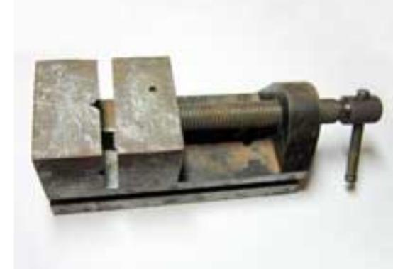
~~Тиски~~ - тиски для фиксации заготовок при обработке
